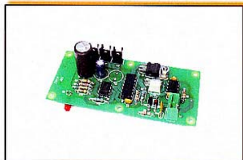
Basetta per fanale amovibile coda treno. Ctg. FS 506/704 a 3 led rossi
