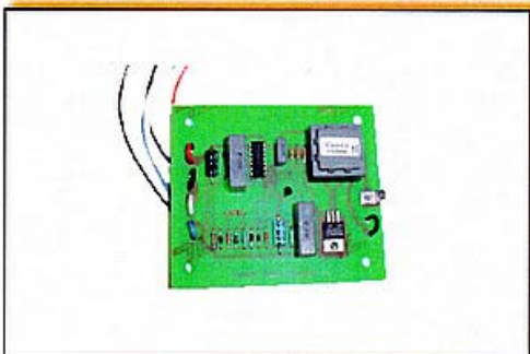
Basetta per fanale coda treno luce pulsante. Ctg. FS 341/949
