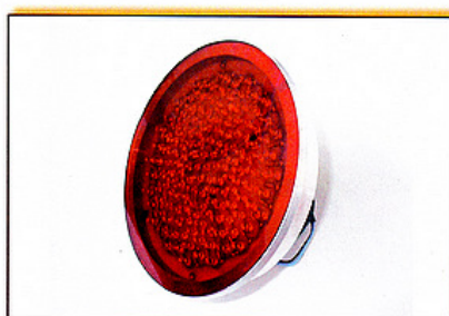
Gruppo Ottico Ø 170 a 108 led rossi ad alta luminosità ripartito su 33 stringhe compatibile con Ctg. FS 506/693
